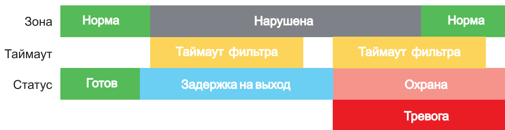
Рисунок 12. Нарушение зоны в момент постановки на охрану.
