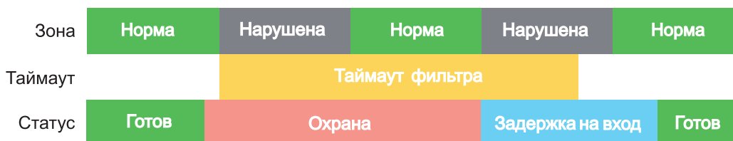
Рисунок 10. Начало задержки на вход при втором нарушении зоны Вход-выход.
